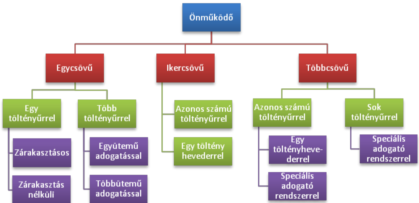
2. ábra Repülőfedélzeti tűzfegyverek felosztása az újratöltés művelete szerint
