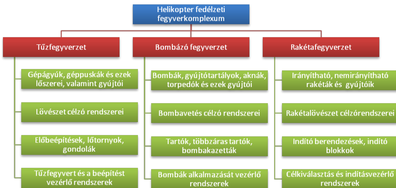
1. ábra A helikopter fedélzeti fegyverzet komplexum
